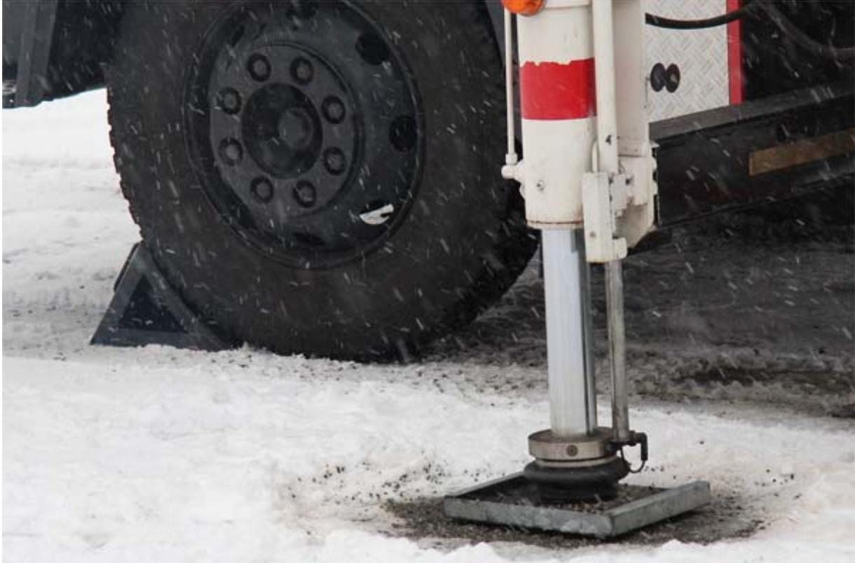
**Bild:** Drehleiter abstützen im Winter. Hier Metz mit Eisschuh, vorher wurde die Fläche von Eis und Schnee befreit. Radkeile liegen unter dem Rad der Vorderachse. **Streusalz** kann verhindern, dass die Fläche vereist.
