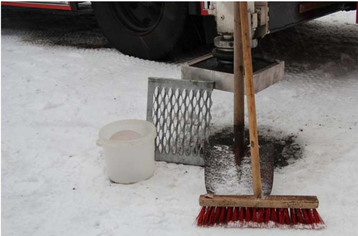
**Bild:** sinnvolle Ergänzung der Ausrüstung für eine Drehleiter im Winter. Hier Metz-Abstützung mit Eisschuh.
