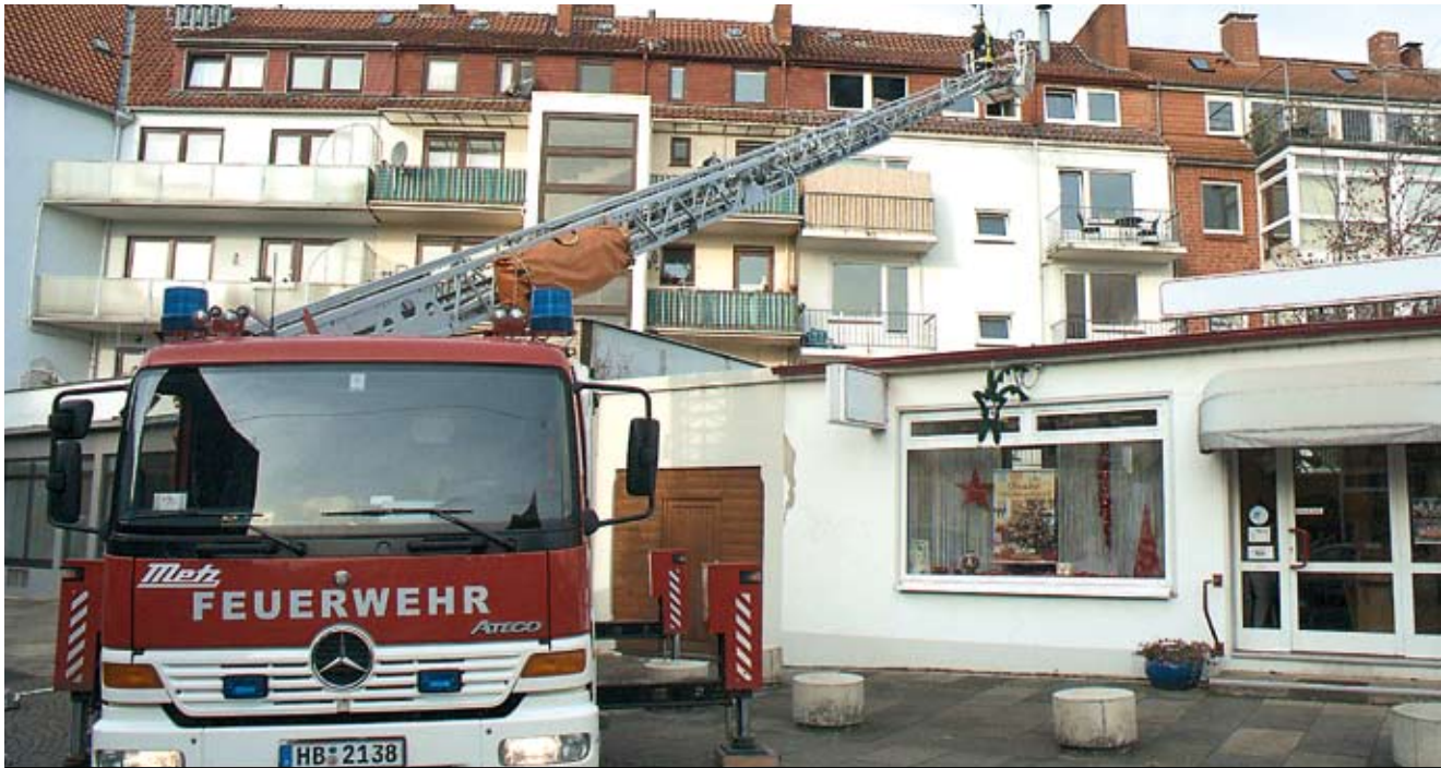
Schwierige Ausbildungs- oder Einsatzlage? In dieser Situation, bei der die Abstützung und der direkte Anleiterweg behindert werden, ist das ganze Können des Drehleiter-Maschinisten gefragt, zumal die Ausladung zum Anleiterpunkt sehr groß ist. Hier zahlt sich eine gute Ausbildung doppelt aus.
