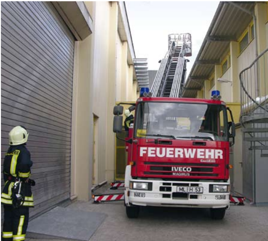
Im Rahmen der Ausbildung zum Maschinisten für Hubrettungsfahrzeuge sollte die schnelle und richtige Fahrzeugaufstellung auch bei beengten Platzverhältnissen trainiert werden.
