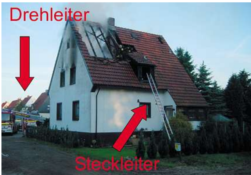
Anleiterbereitschaft an der Vorderseite des Gebäudes mit einer Drehleiter und auf der Rückseite mithilfe einer Steckleiter
