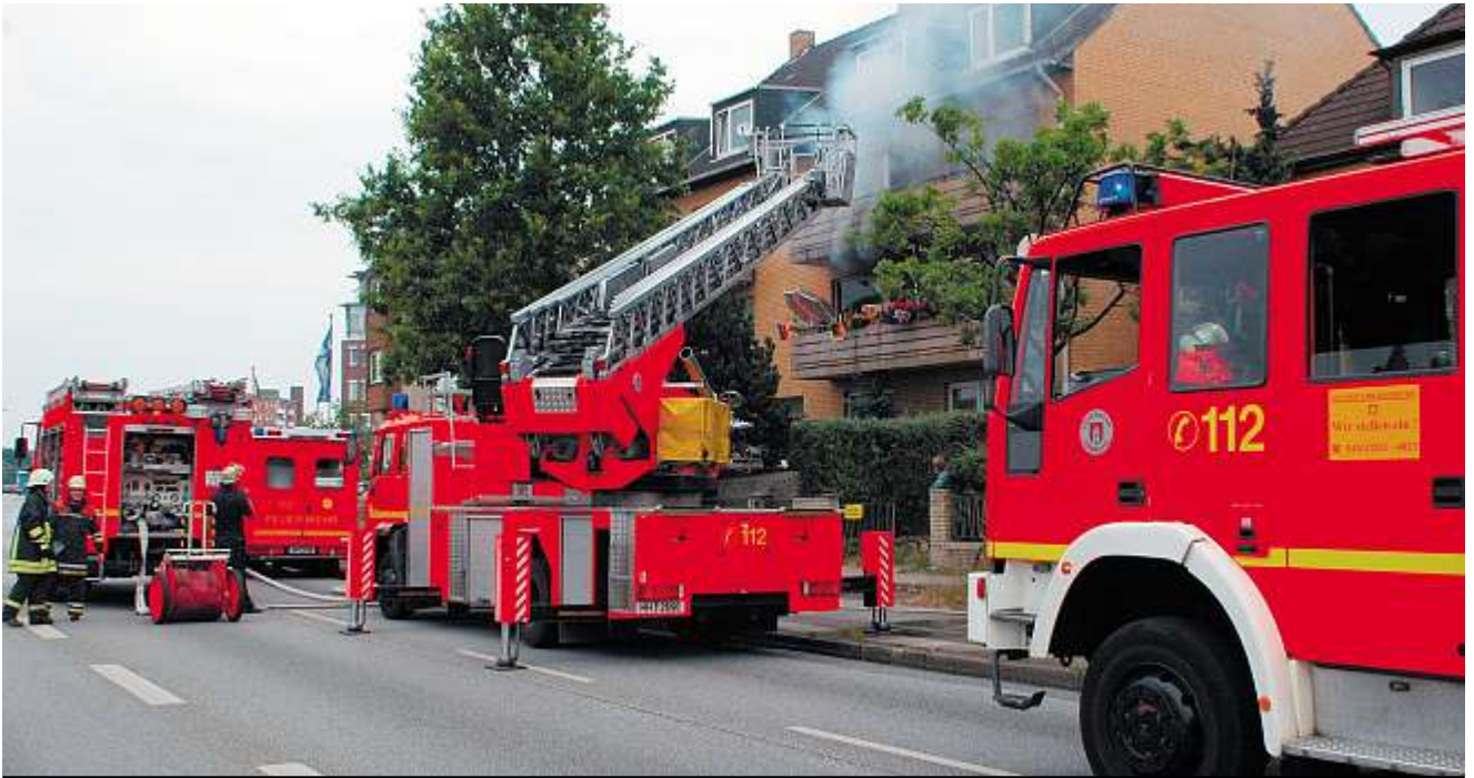
Anleiterbereitschaft mit einer Drehleiter in Hamburg: Die Anleiterbereitschaft ist ein wichtiges Element zur Sicherstellung eines alternativen Rückzugsweges für die im Innenangriff vorgehenden Atemschutztrupps.
